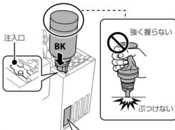
ボトルを正しい色の注入口に挿すと、注入は自動で始まります。注入が開始されないときは、ボトルを挿し直してください。
